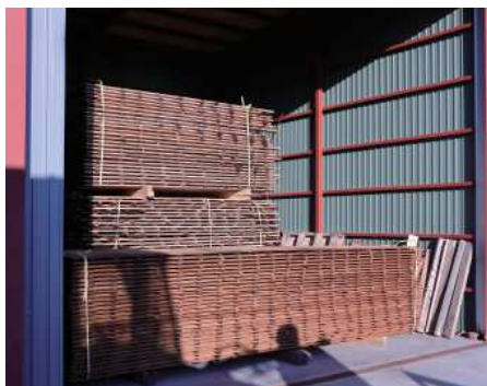
加工した木材はこの倉庫内で乾燥させる。
