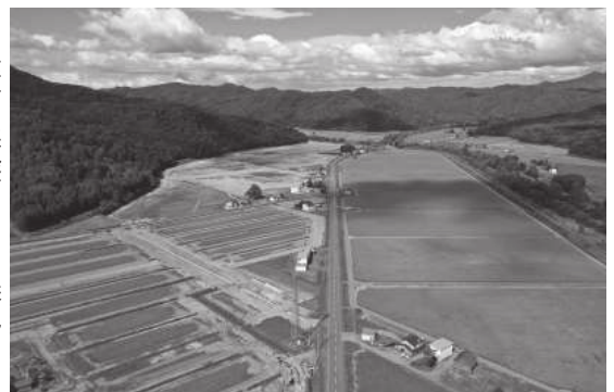
生産の基盤となる農地については、ほ場の大区画化と透排水性の改善として、平成29年度から愛別地区国営緊急農地再編整備事業によるほ場整備工事に着手しているところですが、4年目を迎え、伏古及び協和地区に加え、愛別地区、中央地区においても工事が実施される見込みであり、今後引き続き関係機関・団体と協力して事業促進に努めていきます。
